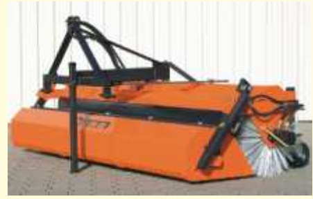
bema 25 Schlepperanbau Dreipunkt Heck (hydr. Schmutzsammelwanne)
