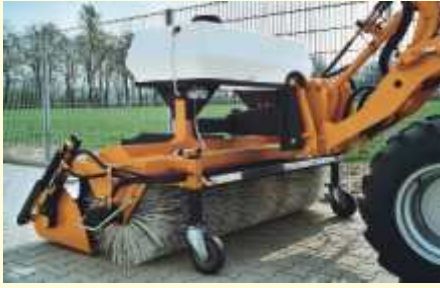
bema 25 Komplettausstattung (Schnellwechselanbau Radlader, Wassersprühanlage 240 ltr., hydr. Seitenkehrbesen). Für sämtliche Funktionen ist nur ein doppelwirkendes Steuergerät erforderlich.
